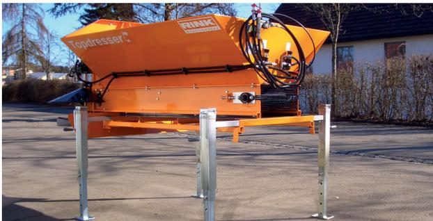
**Abstellstützen** für die sichere und schnelle Montage und Demontage auf Trägerfahrzeugen.
