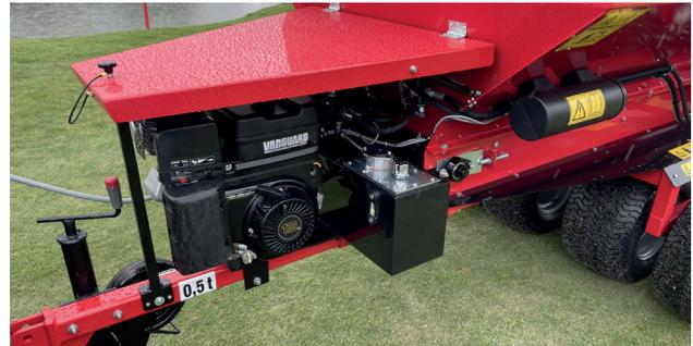
Mit Verbrennungsmotor angetriebenes externes Hydraulikaggregat.
