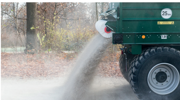
Die Maschine kann mit breiten Ladeschaufeln schnell und effizient geladen werden (hinten 2,00 m / seitlich 3,00 m)
