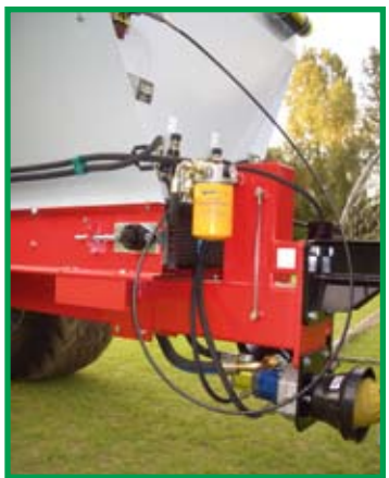
Topdresser DS 3800 mit integriertem Tank u. Tandempumpe
