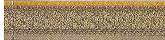
1 Deckschicht, 2 dynam. Schicht, 3 Tragschicht, 4 Filterschicht, 5 Baugrund.
