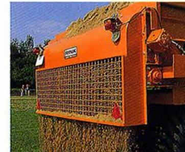
Einsatzfoto bei der Besandung eines Fußballfeldes. Die Streumenge beträgt auf dieser Abbildung 10 mm.
