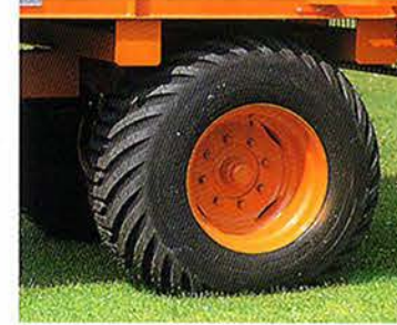
Die Abbildung zeigt die Spezialbereifung 600/50-22,5. Bei voller Zuladung von 4,3 Kubikmetern (Master GS 30) und einem Kubikmetergewicht des Sandes von 1500 kg wird der Bodendruck auf 0,84 kg/cm 2 herabgesetzt.
