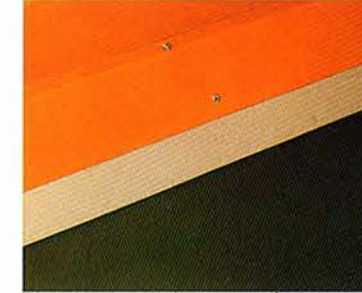
An drei Seiten wird das Transportband mit einer Gummileiste abgedichtet. Dadurch wird verhindert, daß das Streumaterial zwischen das Transportband kommt oder herausfällt.
