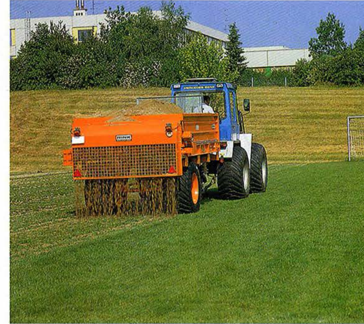
Einsatzfoto bei der Besandung eines Fußballfeldes. Die Streumenge beträgt auf dieser Abbildung 10 mm.
