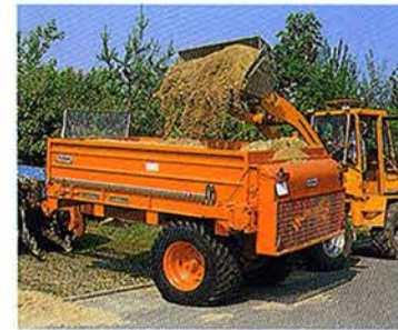
Die Kastengröße von 2 m x 3 m ermöglicht ein leichtes Beladen mit dem Frontlader. Fassungsvermögen Master GS 30: 4,3 Kubikmeter.
