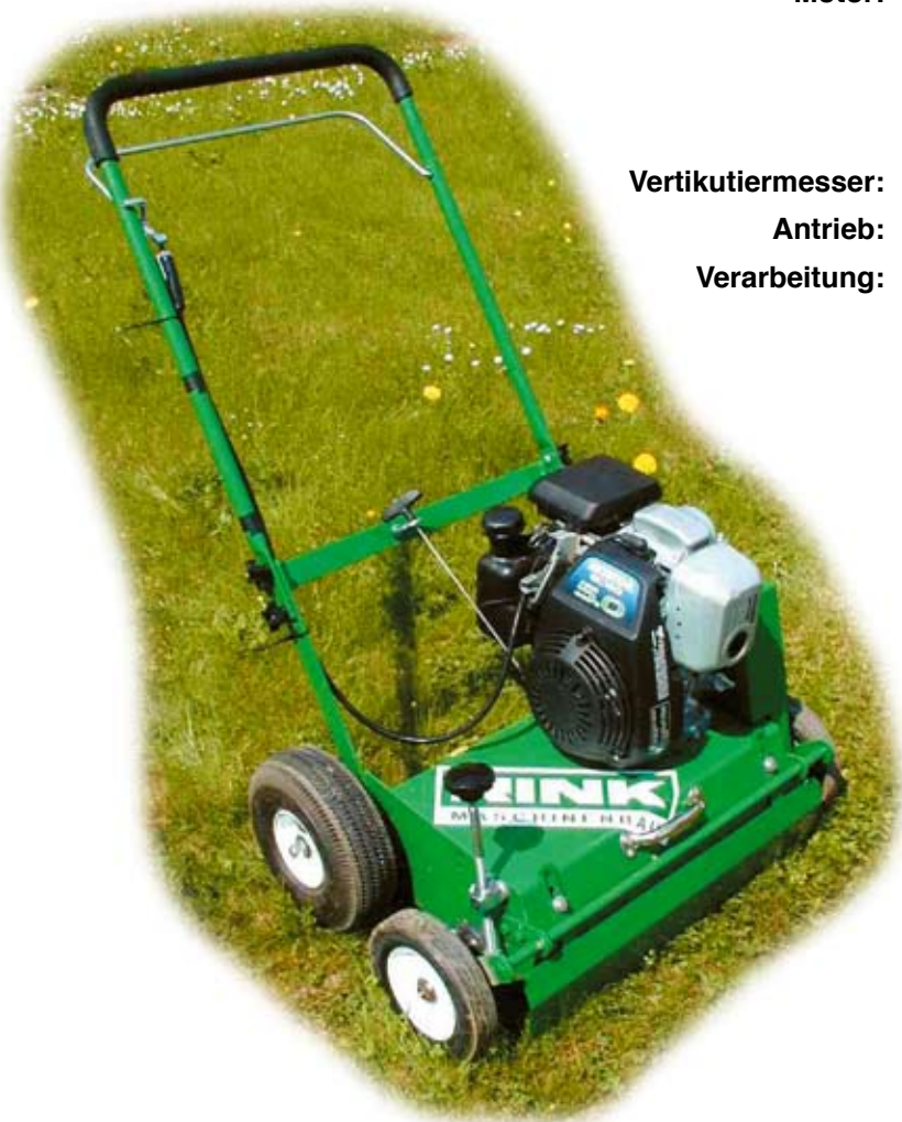
Die Messerzahl kann von 15 auf 30 Stück beliebig erweitert werden.
