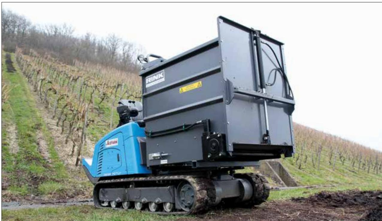
Maschine mit hydraulischer Bordwand und umlaufendem, hydraulisch angetriebenem Kratzboden.
