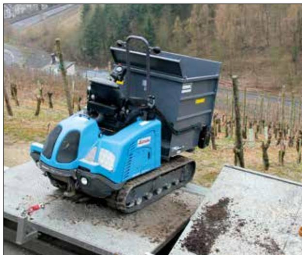
Die Größe des **RINK Schmalspurstreuer WBS 10** wurde auf die Abmessungen des Transportanhängers angepasst.
