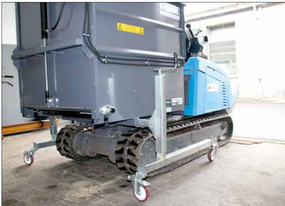
Der **RINK Schmalspurstreuer WBS 10** wurde so konzipiert, dass er mit Hilfe des Standardhebewerkes aufgenommen werden kann. Die Maschine lässt sich ohne bauliche Veränderung mit wenigen Handgriffen auf dem Trägerfahrzeug montieren.
